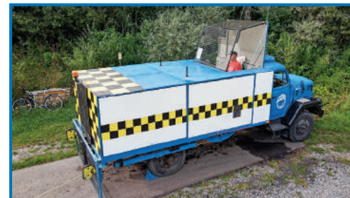
▲ Doppeltrommelwinde der Marke Eigenbau mit ca.330 PS.
