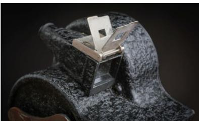
Eine Version des Obenauf- und eine des Seitensuchers weisen einschwenkbare Formatmasken auf, wie sie bei Eastman-Kodak üblich waren. Billig, brauchbar
