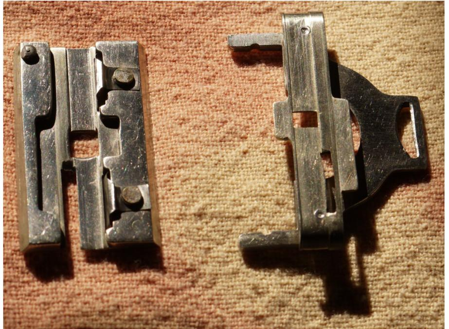
Die jüngeren Modelle, Miami und Star, haben eine passive Filmführung an den Wickeltrommeln und eine passive Seitenführung im festen Kanal.
