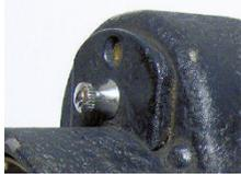
Bei den frühen Modellen wurde ein Bilderzählerkasten angesetzt. Erst mit der 1940er Linie wurde eine neue Druckgußform für die Gehäuseschale verwendet.
