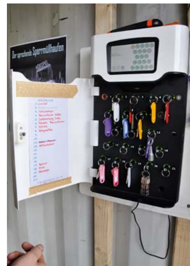
Die Schlüssel zu den Gemeinschaftscontainern sowie zu Sicherungsbolzen am Werkzeug befinden sich im digitalen Schlüsselkasten, den jeder mit einem persönlichen Code öffnen kann. Person, Handynummer sowie die Zeit der Entnahme werden dokumentiert.
