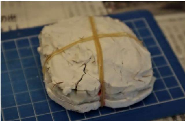
前記の合わせ目をたよりにしっかりと上下を合わせて縛ります。型を振ることで型内部の細かい凹凸に石膏が入ります。
