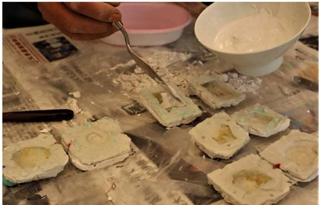
上下の型に石膏を入れます。石膏と水の配合は1対1。混ぜながらんぷら粉を溶いた硬さにします。
