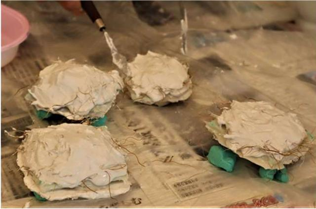
同様に反対側のシリコン雌型を作り、石膏でそれを覆い、シリコン型を補強します。石膏には麻ひもをほぐしたものを混ぜて壊れにくくします。
