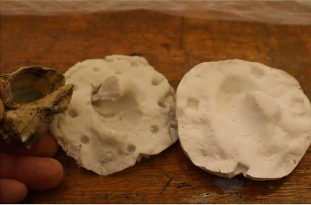
これが雌型の片面。シリコン型とシリコン型を補強する石膏、の2層から成る。シリコン型の穴は、もう一つの片面と合わせる際のホゾになる。
