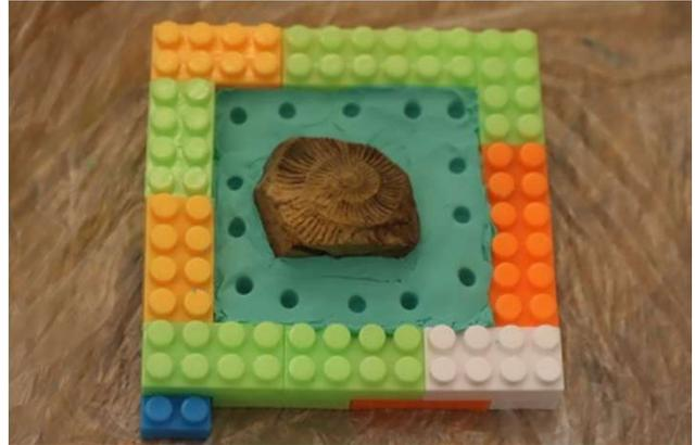
おもちゃのブロックで外枠をつくる。化石を置き、油粘土で周囲を隙間なく埋める。
