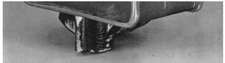
3. Zur Frontplatte hin sieht das Gehäuse abgefeilt aus, ohne Rücksicht auf den Anschluß. Der umlaufende Gehäusesims ist über ein wenig mehr als die Frontlänge weggefräst.
