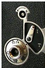
werfen bei mir Fragen auf, zum Beispiel wie weit die Handkurbelwelle aus dem Gehäuse ragt. Bei den älteren Kameras, Abbildung links, muß man das Werk aus dem Gehäuse nehmen, um an den Querstift heranzukommen, bei den jüngeren, rechtes Bild, kann man den Stift von außen erreichen. Warum? Wozu sollte man rasch ausstiften können, wenn man danach bloß die darunter liegende Hülse abziehen kann? Darauf werde ich zurückkommen.
