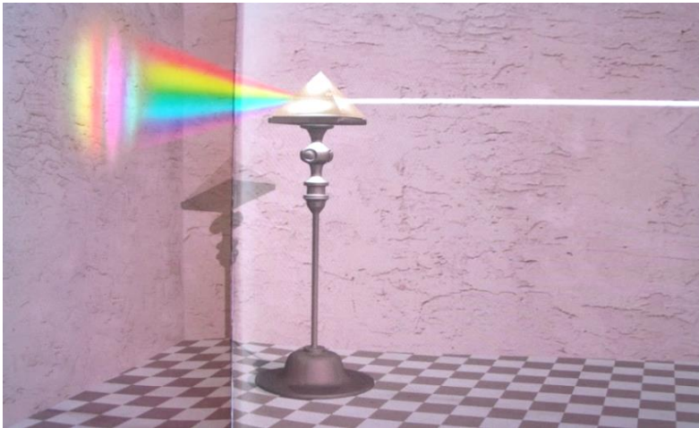
Fig. 3. La descomposición de la luz al ser refractada al atravesar un prisma, descomponiéndose en el espectro visible. De esta forma interpretó el enigma el arco iris.
