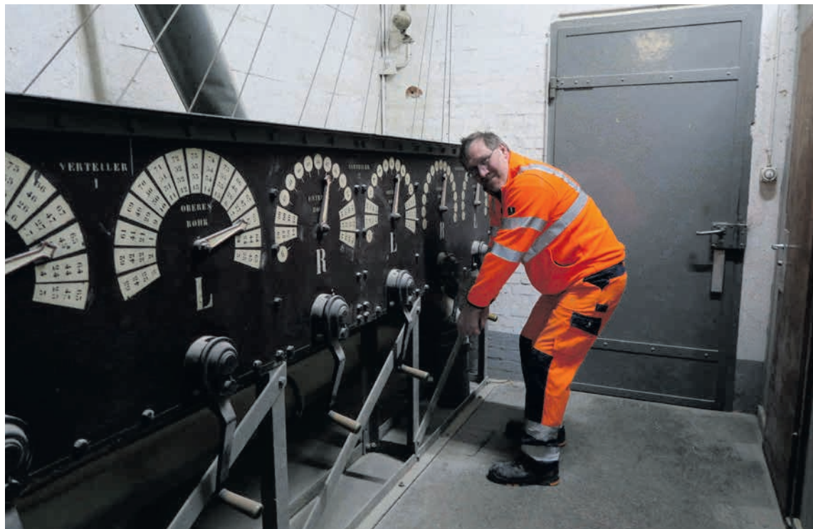
Achim Roscher entscheidet mittels Drehkurbel darüber, welches Silo gefüllt wird. (Bilder: Martin Regenass)
