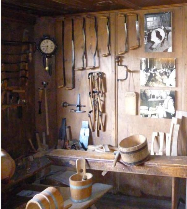
Abbildung: 37 Eine typisch eingerichtete "Schnefeler"-Werkstatt, in der verschiedene Werkzeuge ausgestellt werden, die zur Holzbearbeitung (Schnefeln) notwendig waren und mit denen z. B. die auf der Abbildung zu sehenden Holzkübel hergestellt wurden. In solchen Werkstätten, die in vielen Eindachhöfen zu finden waren, wurden Gegenstände des täglichen Hausgebrauchs hergestellt. © Peter Schach
