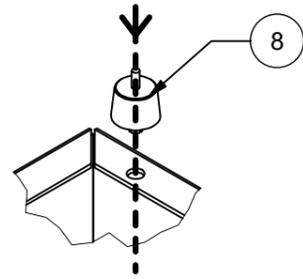
Nehmen Sie die Gehäusefüße und befestigen diese mit einem handelsüblichen Hammer in den dafür vorgesehenen Bohrungen
