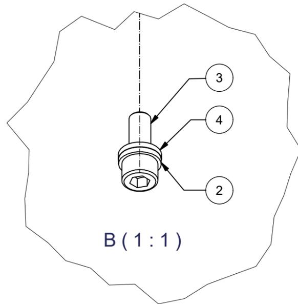
Verschrauben Sie nun die beigelegten Schrauben Schraube - Federring - U-Scheibe
