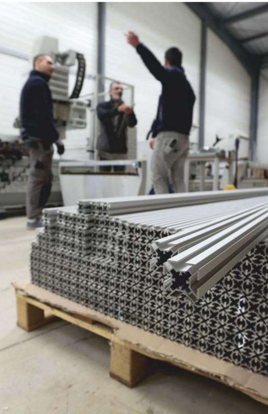
Tout commence avec des profils aluminium livrés en barres de 4 m. Le centre d'usinage les découpe, les perce et les assemble pour la gamme Panoramic. La cadence suit le rythme de la demande. La recyclabilité de l'aluminium est l'un des éléments fondateurs de la démarche RSE initiée en 2007 (cf. p. 70).
