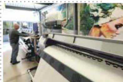
Duo lance l'impression par sublimation sur toile. Un joint silicone est fixé dessus pour qu'elle vienne se clipser dans des cadres.
