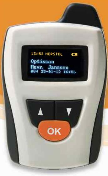
Unser Pager2 ist ein tragbarer Drahtlosempfänger, der zuverlässig und ohne Umwege über andere Geräte direkt mit unseren Alarmsendern kommuniziert. Er ist kompakt, sehr solide gebaut, besitzt einen stabilen Federclip und ein helles, übersichtliches Display.
