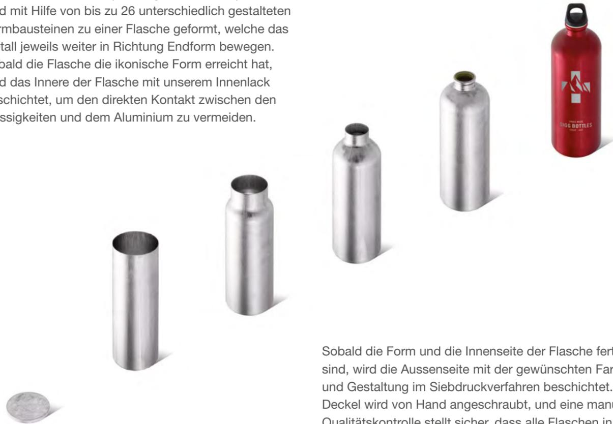
Sobald die Form und die Innenseite der Flasche fertig sind, wird die Aussenseite mit der gewünschten Farbe und Gestaltung im Siebdruckverfahren beschichtet. Der Deckel wird von Hand angeschraubt, und eine manuelle Qualitätskontrolle stellt sicher, dass alle Flaschen in perfektem Zustand sind.
