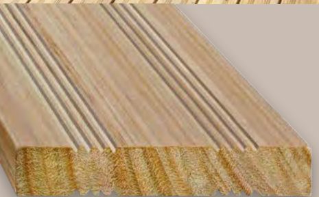
Terrassendiele Eucalyptus Globulus 2,6 cm stark, 14 cm breit, roh, beidseitig gehobelt und partiell geriffelt
