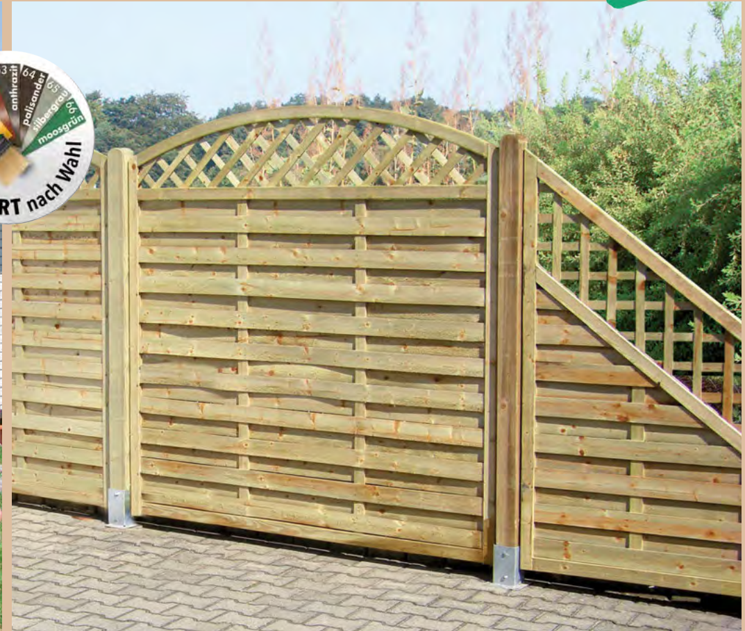
Lamellenzaun Kassel Rahmenteile 3,0 x 5,0 cm gehobelt, Lamellen 0,5 x 7,0 cm, feingesägt, Maschenweite 6 cm, kesseldruckimprägniert
