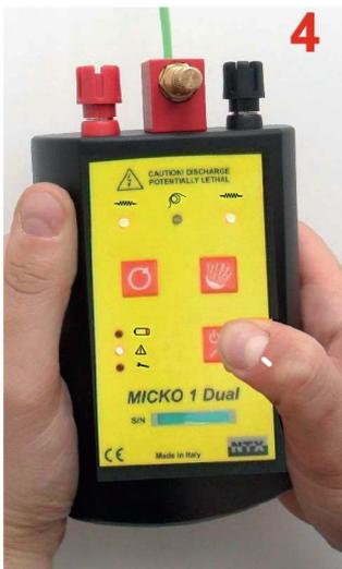
Durch kurzes Drücken der Taste „AN/AUSWAHL“, wählen Sie die Betriebsart. Die jeweiligen LEDs leuchten entsprechend auf.
