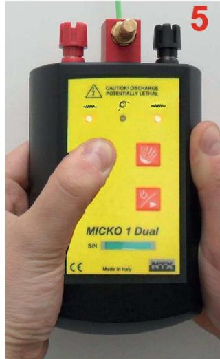
Wenn Sie bereit sind zu sprengen, laden Sie den Kondensator durch gedrückt halten der Taste „LADEN“. Wenn der Kondensator geladen ist blinken die LEDs der zuvor eingestellten Betriebsart rot und grün.
