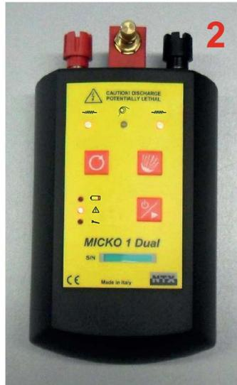
Das Gerät schaltet sich ein und führt einen Selbsttest durch (LEDs blinken rot). Anschließend ist das Gerät betriebsbereit (LEDs leuchten grün).
