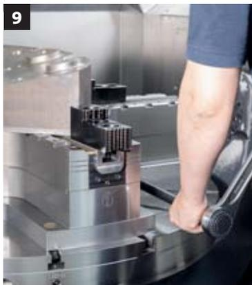
4/5 Ein Drehfutter für alles: Der Ausgleichsmechanismus ermöglicht beim Schunk ROTA-M flex einen deutlich größeren Ausgleichshub als vergleichbare Drehfutter. Damit steigt die Flexibilität hinsichtlich der spannbaren Werkstückgeometrien.
