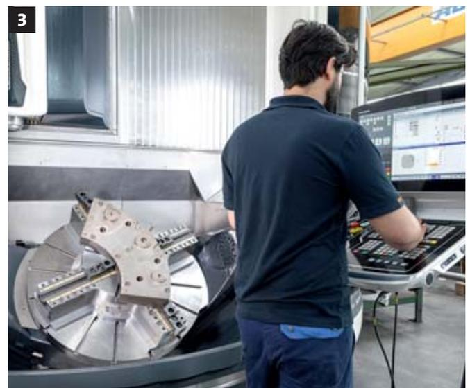
**1** Ein Meter Durchmesser: Mit dem neuen Drehfutter ROTA-M flex 2+2 1000 kann Schumacher im 5-Achs-Bearbeitungszentrum jegliche Teile spezifisch und effizient bearbeiten.
