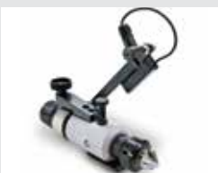
Art.-Nr. 11280 Senker- und Fräuserschleifvorrichtung SZVR für dreischneidige Kegelsenker von 6-31 mm oder bis MK3, sowie für ein- bis vierschneidige Fräser zum stirnseitigen Anschleifen bis 20 mm. inkl. 10 mm Spannzange
