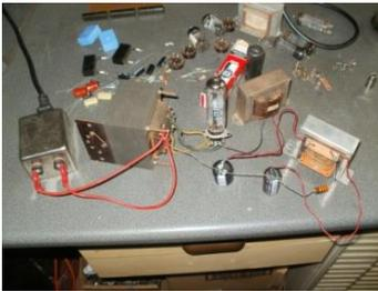
nous dirons les récepteurs élémentaires. La condition de réussite est de faire quand même des connexions courtes, quelques centimètres au plus. Ils sont très lisibles pour les novices, dont l'éducation ne peut se faire que par l'assemblage raisonné de circuit.
