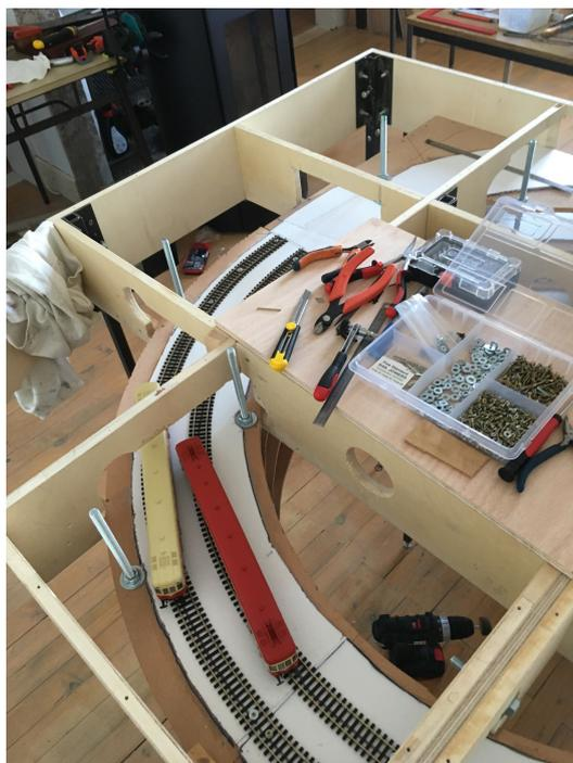
Cette étape validée, on pourra poursuivre la fixation des rails le long de la rampe. On laissera de côté l'entrée et la sortie de la rampe qui seront raccordées plus tard au réseau.
