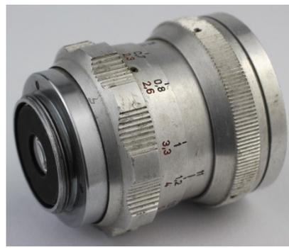
Als Wiederholung: Der C-Anschluß ist das Gewinde UN 1"-32, das heißt NennØ ein Zoll oder 25,4 mm, Steigung 32 Umgänge pro Zoll oder 0,79375 mm und Flankenwinkel 60°.
