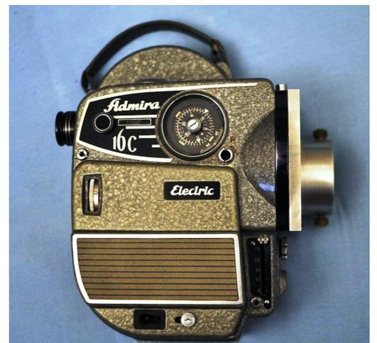
Offensichtlich war die Motoreinheit abnehmbar, schmäler als der ESM zur Paillard-Bolex-H.
