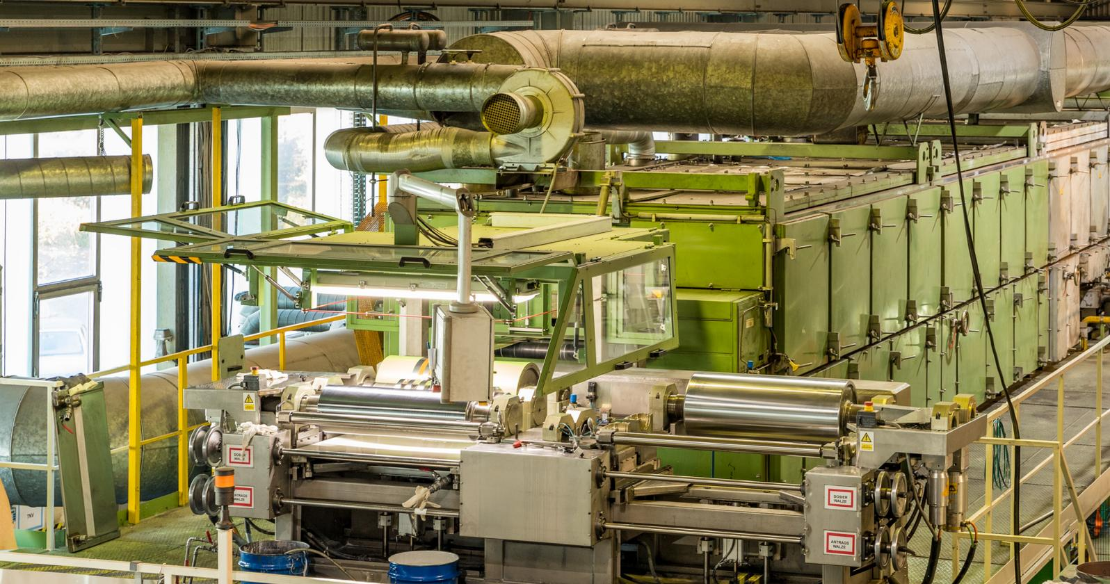
Algo único: pintado de bobinas en nuestra instalación de pintado continuo coil-coating
