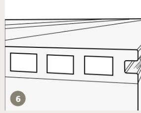
**6** Bei der letzten Diele setzen Sie Aufnahmebohrungen in einem Winkel von 45° zwischen die Nutwangen am Rand der Diele in die Mitte der Unterkonstruktion. Schrauben Sie die Diele fest.
