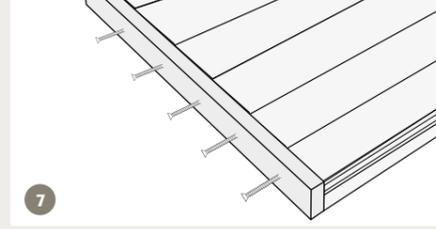
**7** Falls Sie ein Abschlussprofil an die Dielenenden montieren müssen, setzen Sie zunächst die Vorbohrung durch das Abschlussprofil in die Dielseite oder Unterkonstruktion, sodass das Abschlussprofil bündig mit der Dielenoberseite verschraubt werden kann.
