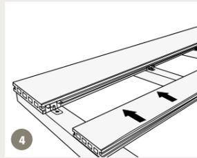
**4** Schieben Sie sanft die zweite Diele gegen alle Clips und stellen Sie sicher, dass alle Clips in die seitliche Nut der zweiten Diele passen.
