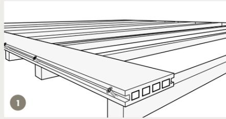
**1** Befestigen Sie die erste Diele. Setzen Sie Aufnahmebohrungen in einem Winkel von 45° zwischen die Nutwangen am Rand der Diele in die Mitte der Unterkonstruktion. Schrauben Sie die Diele fest. Die Dielen sollten in Längsrichtung ein Gefälle von 1% (1 cm/m) aufweisen.
