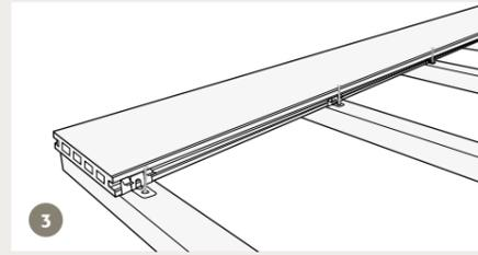
**3** Bohren Sie durch das Loch des Clips vor und schrauben Sie diesen an der Mitte der Unterkonstruktion fest.
