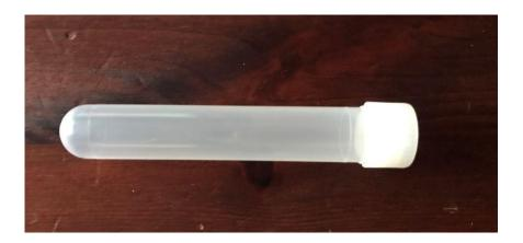
Klares Probenröhrchen, weißer Schraubdeckel mit Saugdeckel mit hellem Käppchen. Kann aufgezogen werden wie eine Spritze und enthält klappernde Kügelchen (milchig, plastikartig wirkend), Aufschrift "Serum"; -nicht mehr verwenden-
