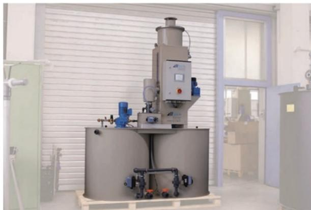
Bild: Alltech Polymeransetzstation Continufloc von HENNLICH
