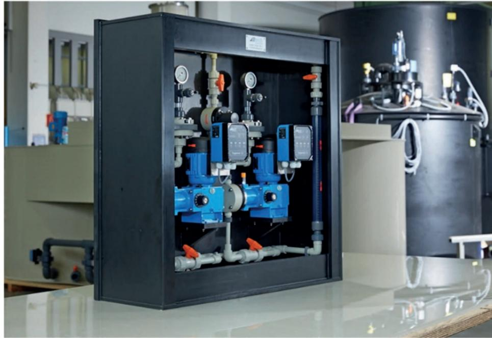
Bild: Beispiel für ein Eisen-III-Chlorid Dosiersystem
