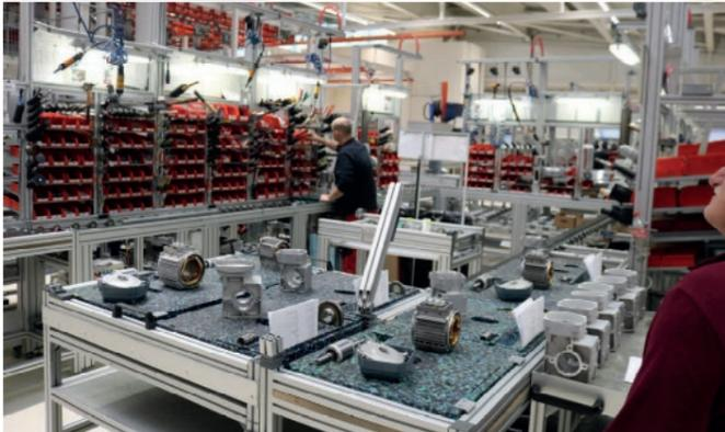
Einer der Montageplätze, wo die Getriebe und die Motoren zusammengesetzt werden. Im Vordergrund die Paletten, die vom ETW transportiert werden.
