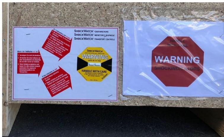
Рисунок 2. Расположение индикатора удара
