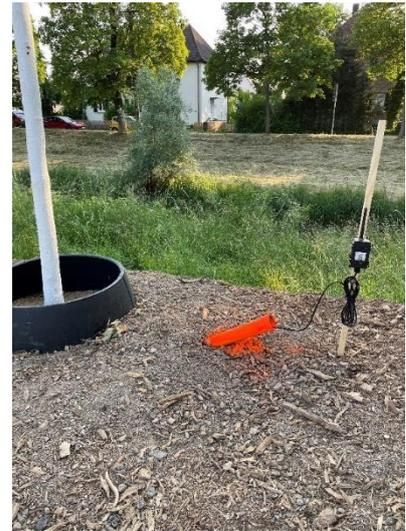
**Abbildung 10:** fertig installierter und einsatzbereiter Bodenfeuchtesensor mit Funkeinheit
