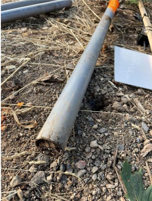
**Abbildung 19:** mit Umgebungssubstrat verstopftes PVC-Rohr
