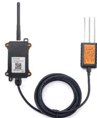
**Abbildung 5:** Bodenfeuchtesensor „Dragino LSE01“
