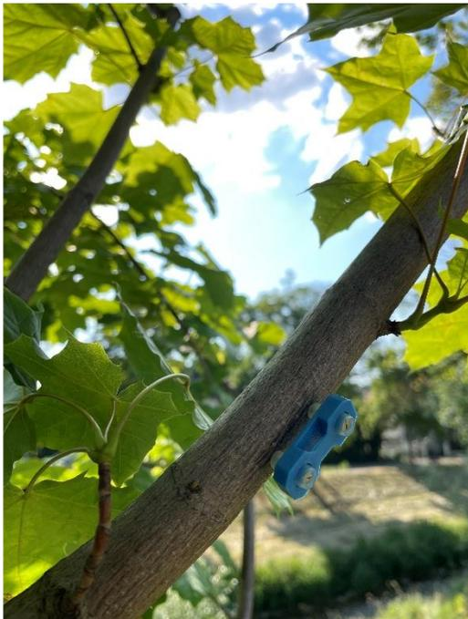
**Abbildung 6:** eingebohrte Elektroden
