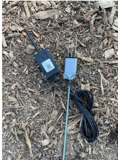
**Abbildung 9:** Bodenfeuchtesensor LSE01 mit verbundener Gewindestange als Einbauhilfe
