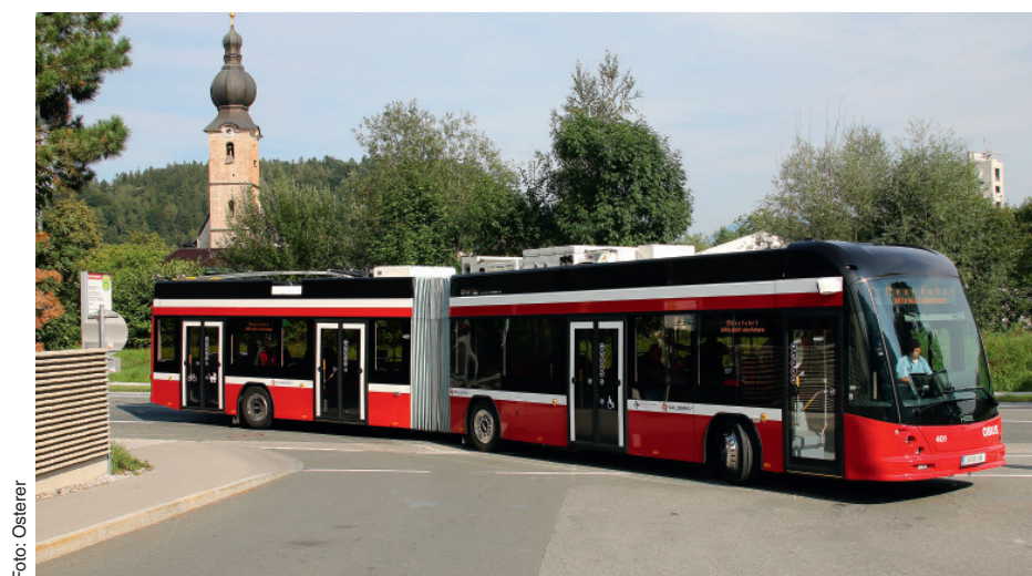
Abb. 6: In der Gemeinde Grödig verkehrt der eObus fast neun Kilometer je Umlauf ohne Fahrleitung.
