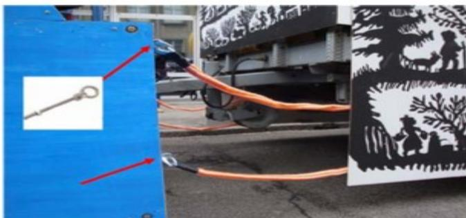
Solide Befestigung der Gummiseile
