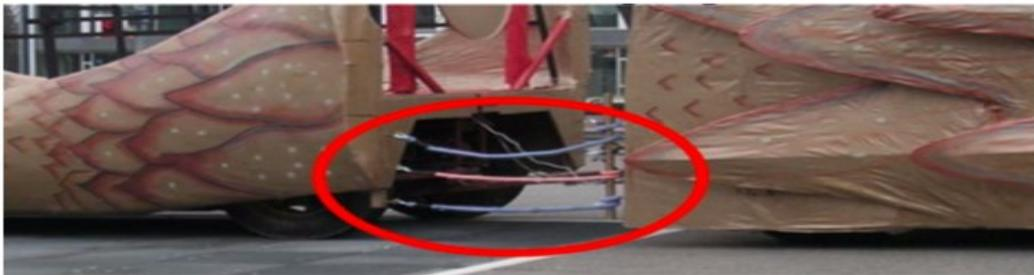
Eine gute Sicherung mit Gummiseilen zwischen Zugfahrzeug und Anhänger.
