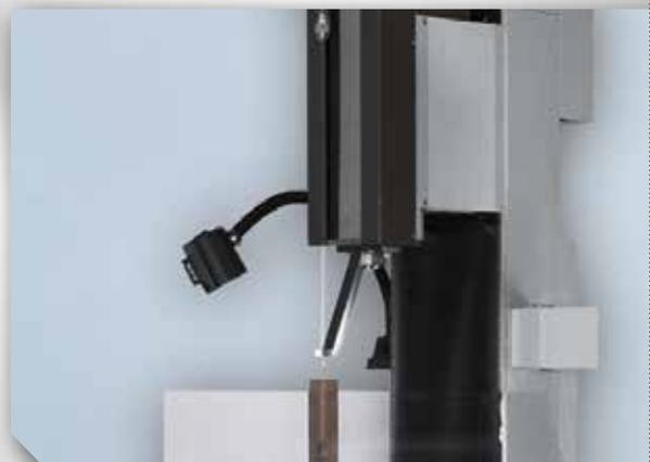
Kopferhöhung zur Bearbeitung hoher Werkstücke
