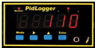
Alle unsere Öfen sind mit Datalogger ausgerüstet und erlauben die Verfolgbarkeit, das Drucken / Speichern des zeitlichen grafischen Verlaufes der Temperatur (für SAHARA) und der Temperatur / Feuchte (für SAHARA DRY). Für die Analyse der Daten des Dataloggers und für die Programmierung der thermischen Steuerung, wählt man die Option **8107.215** Software PidManager mit dem USB-Spezialkabel.
