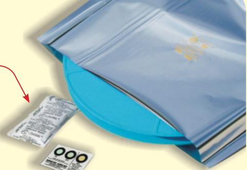
Für das Schweissen von Trocken-Verpackungen schreibt J-STD-033 kein Vakuum vor. Das Vakuum ist jedoch nützlich, um das Packvolumen zu reduzieren. Dazu empfiehlt die Norm eine leichte Evakuierung der Luft. Eine übermäßige Evakuierung behindert die korrekte Wirkungsweise der Indikatorstreifen für die Feuchte sowie der Trocknungselemente und kann eine Perforation des Beutels verursachen.
