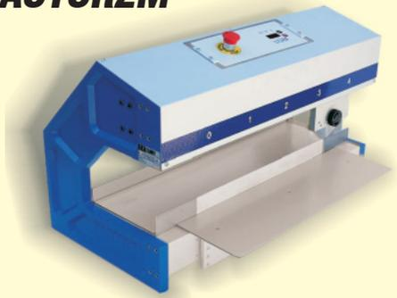
TRACTOR 2 ist ein Nutzentrenner für geritzte Platinen mit einer Schnittlänge bis zu 450 mm. Die Platine wird mit einer Ritze auf das Linearmesser gelegt. Die Trennung erfolgt mit dem runden Messer von Hand oder mit Motor. Der Abstand zwischen dem runden und dem Linearmesser ist einstellbar.
