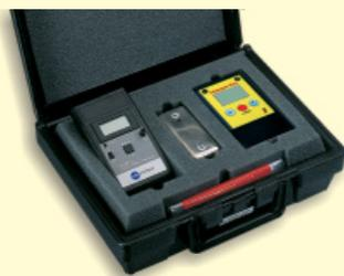
Das 9265.403 ist ein Kalibriersystem für Ionisiergeräte und enthält eine abnehmbare Ladungsträgerplatte und ein Feldmeter mit Entladegerät. Zusammen bilden die drei Komponenten ein Me\_system zum Messen der Abklingzeiten und der Effizienz von Ionisiergeräten.
