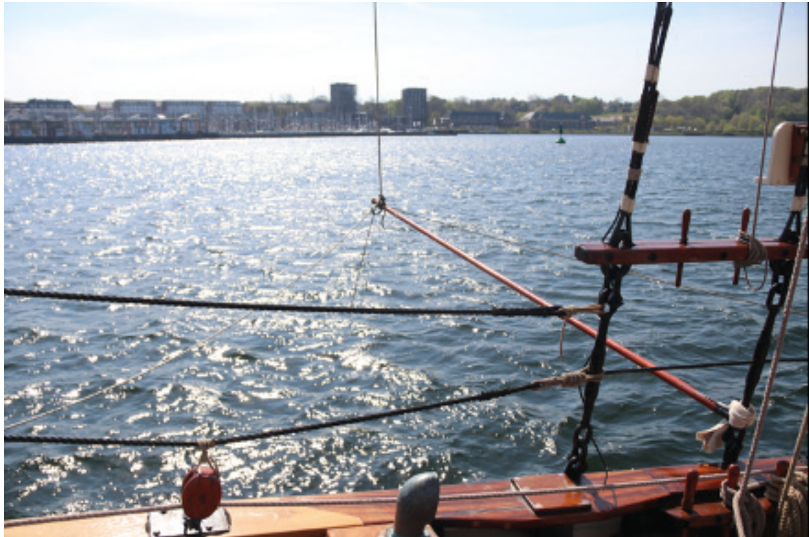
Ausbaumer mit Fall und Sicherungsleinen nach vorn und achtern
