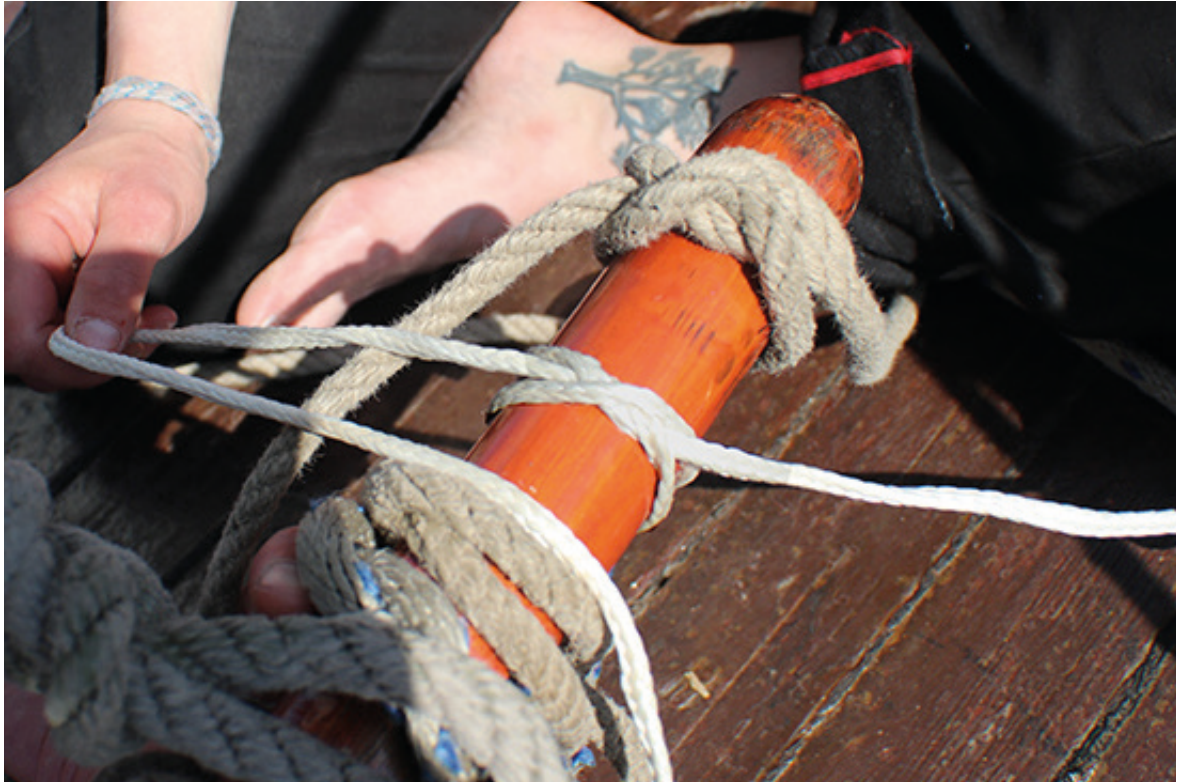
Befestigung am Ausbaumer hier mit einem Würgeknoten
