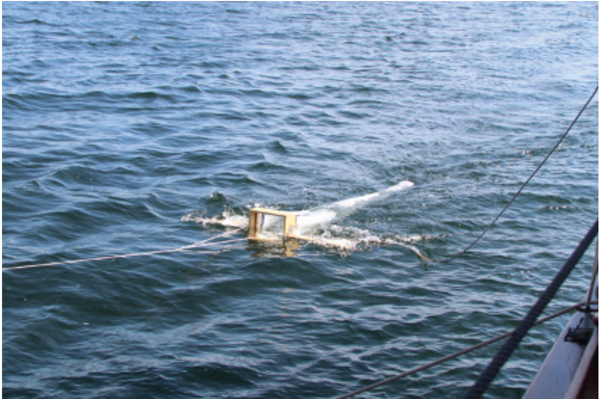
Richtige Schwimmposition des Manta Trawls
