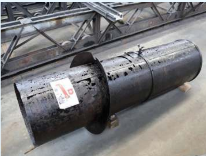
Schornstein-Unterteil und Rauchrohr und Krägen liegen in der Werfthalle in Romanshorn. Fotos Uhlig
