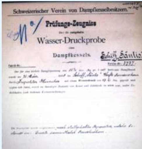
Prüfungs-Zeugnis zur Wasserdruckprobe am Dampfschiff „SANTIS“ vom 22. April 1898. Foto: Schweizerisches Bundesarchiv / Sammlung Uhlig
