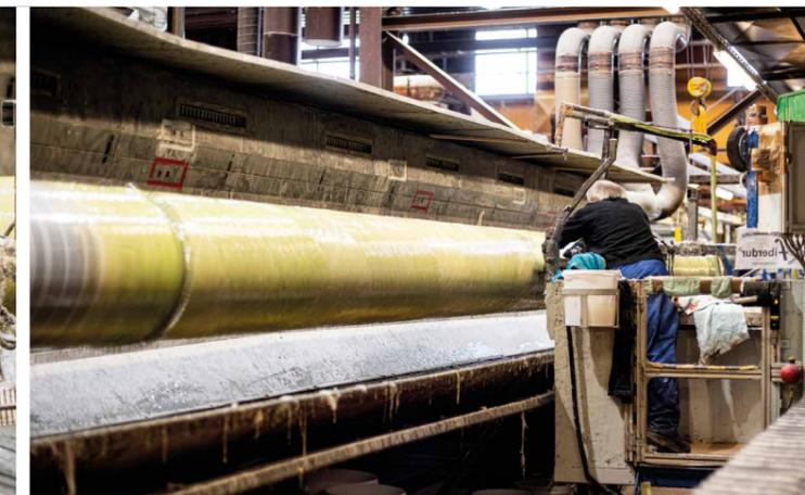
Vier Tage, rund um die Uhr: Die Mitarbeiter von Fiberdur arbeiten in drei Schichten, denn bei längeren Pausen würde das Harz klumpen.
