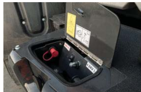
Elektrisch öffnende Motorhaube und Batterie-Hauptschalter. Anschlüsse für den Fremdstart.
