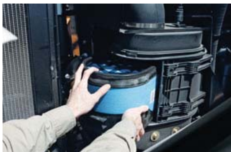
Der Luftfilter lässt sich problemlos ausbauen und Staub wird durch den Auspuff angesaugt und ausgeworfen.
