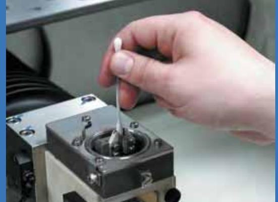
Bei der Wartung muss berücksichtigt werden, dass durch die Auslegung der Pico-Führungen als geschlossenes Rundsystem Schlamm in der Führung anhaften kann. Makino hat ein spezielles Doppelstrahl-System entwickelt, das den Schlamm bei jedem Einfädelvorgang aus der Führung entfernt. Diese Funktion verlängert nicht nur das Wartungsintervall für die Führungen, sondern erhöht auch die Zuverlässigkeit der Maschine.
