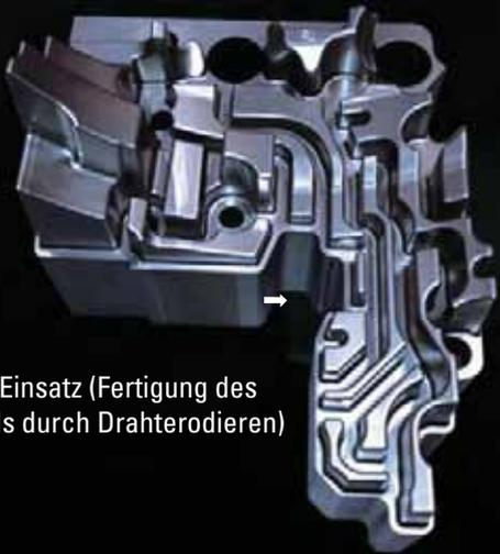
Druckguss-Einsatz (Fertigung des Außenprofils durch Drahterodieren)
