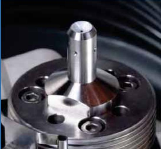
Automatische Drahtefädung in Startbohrungen mit 0,40 mm Durchmesser und einem Abstand von 1 mm
