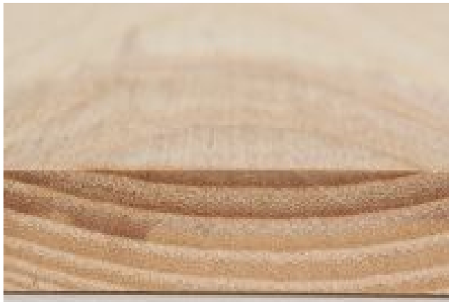
Esche ( Fraxinus spp.) – Querschnitt und tangentielle Oberfläche (natürliche Größe)
