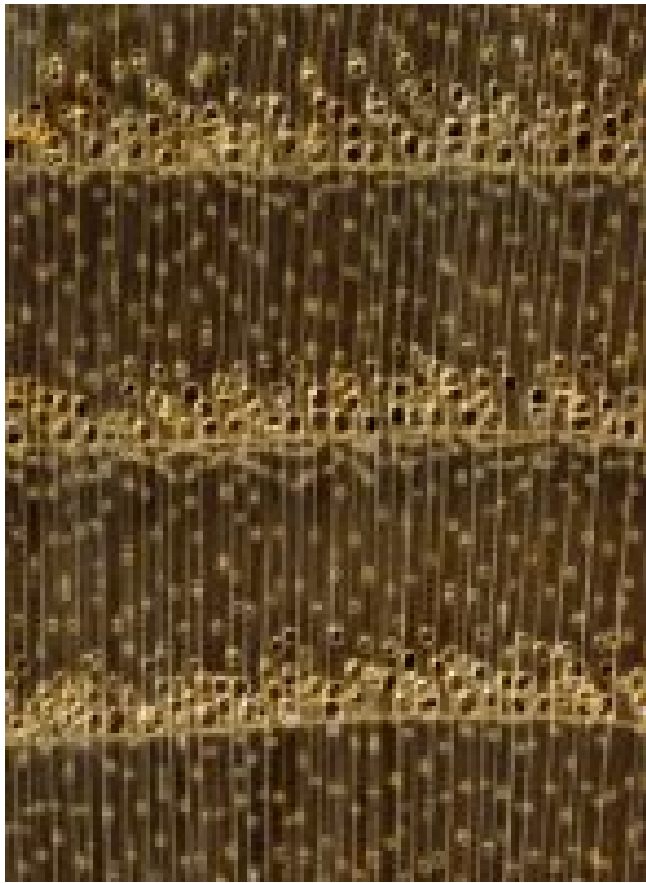
Esche ( Fraxinus spp.) – Querschnitt (ca. 12-fach)
