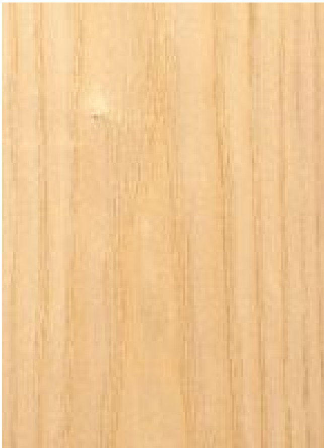
Esche ( Fraxinus spp.) – Tangentiale Oberfläche (natürliche Größe)
