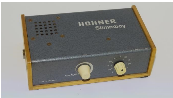
Hohner - Stimmboy Dieses chromatische Gerät diente eigentlich als akustische Hilfe beim Stimmen der Hohner Clavinet-Instrumente, die von Ernst Zacharias entwickelt wurden. Funktioniert mit 9V-Block.
