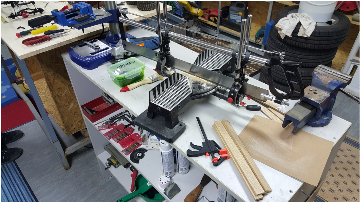
(2) Eichenholz mittels Kappsäge auf die gewünschte Länge bringen
