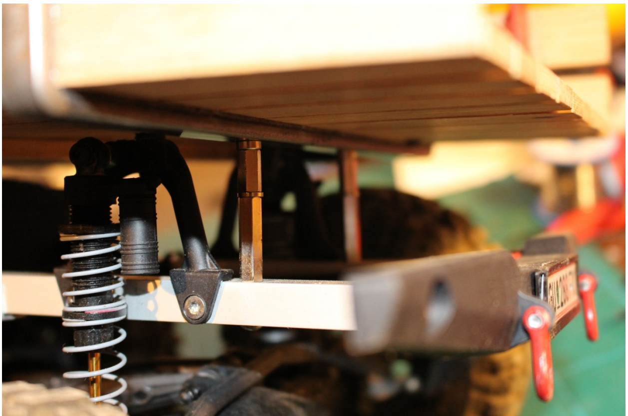
(5) Die Ladeflächen Rahmen sind mit Abstandsbolzen am Chassis verschraubt
