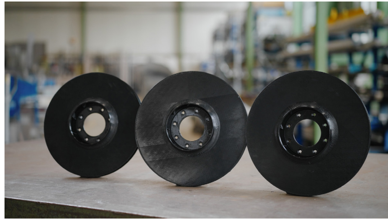
Beim Laufrad hat der 3D-Druck die Vorlaufzeit im Vergleich zur herkömmlichen Metallbearbeitung um bis zu 50 % verkürzt.
