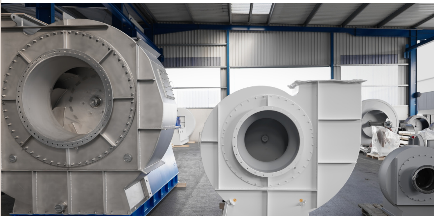
Reitz Ventilatoren baut maßgefertigte Radialventilatoren von der Größe eines Schuhkartons bis hin zu hausgroßen Ausführungen.
