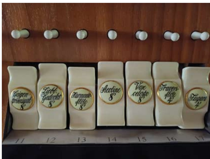
Abb. 11: Pneumatische Registertasten, St. Markus
