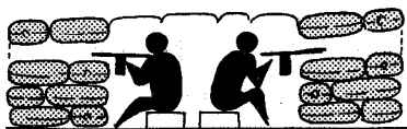
Kampfstand für 2-4 Mann aus Sandsäcken. Anschlag sitzend. Schiesscharte aus Holzkännel. Abdeckung mit Blache, Wellblech oder Bretter gegen Regen und Schnee.
