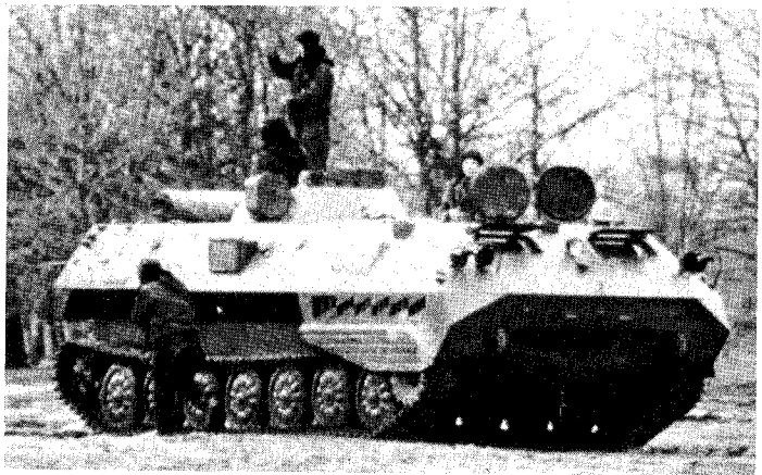
Feuerleitpanzer. Merkmale: hoher kastenartiger Kampfraum von durchgehend gleicher Höhe. Auf der hinteren Hälfte des Kampfraumes ein flacher, kreisrunder Turm mit einem 12,7-mm-Flab-Mg auf offenem Drehzapfen. Das Fahrzeug ist schwimmfähig.
