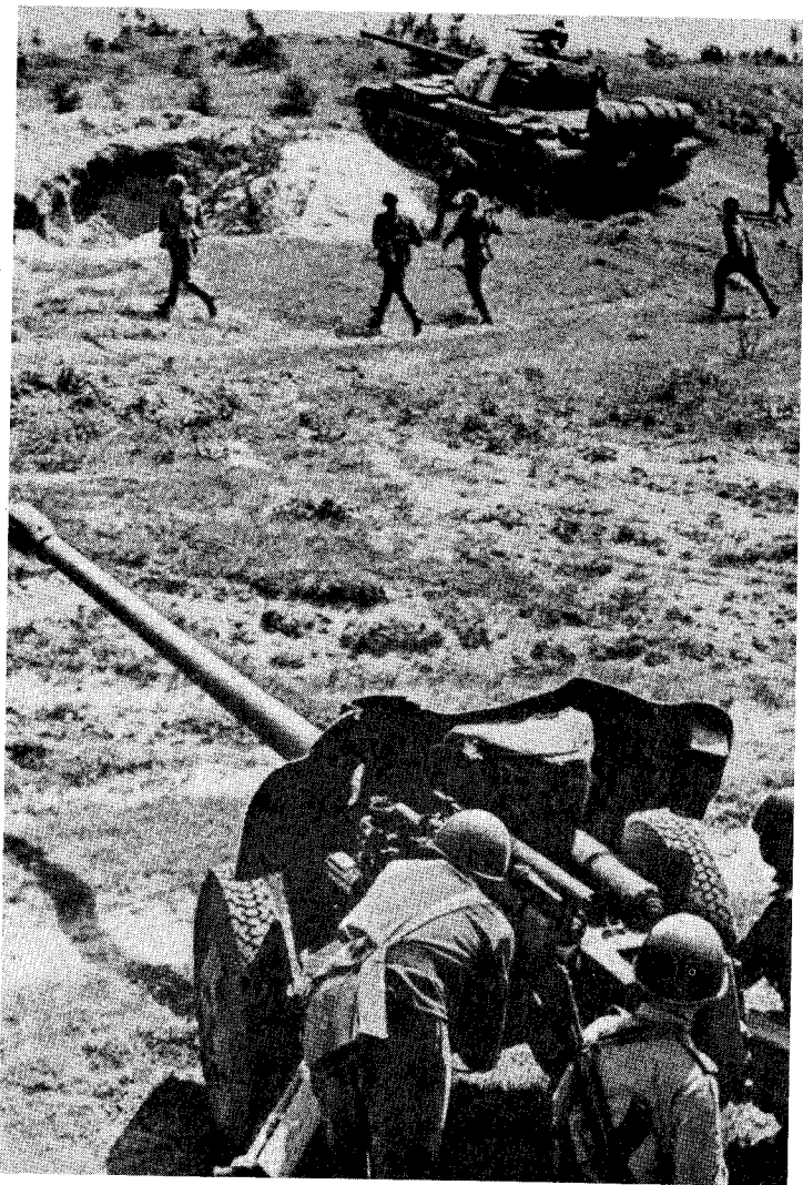
100-mm-Kanone, Gewicht 1,7 t, Reichweite maximal 14 km, V0 900–1200 m/Sek, Geschoss- gewicht ca. 11 kg, Feuergeschwindigkeit 6 Schuss/Min, Zugmittel Lastwagen 4,5 t (6×6). Zuteilung: 1 Abteilung à 18 Rohre im Artillerieregiment der Panzer- und Mot Schützendivision.
