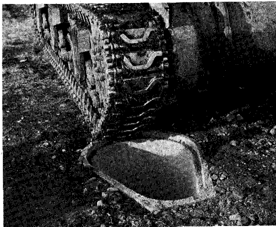
Zementrohr mit Ei-Profil Ø 120 cm, vor dem Überrollen mit Panzer
