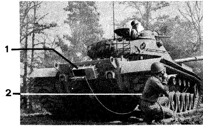
Verbindung Panzer-Infanterie mit Telefon 1 Kasten des Aussentelephons 2 Infanterieführer bezeichnet dem Panzerkommandanten über das Aussentelefon ein Ziel
