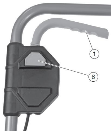
Abbildung 7: Nahaufnahme des Sicherheitsknopfes und des Ein-/Auschalters bzw. Griffs.
