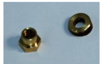
Bild 22: Haltemutter für den Mast
