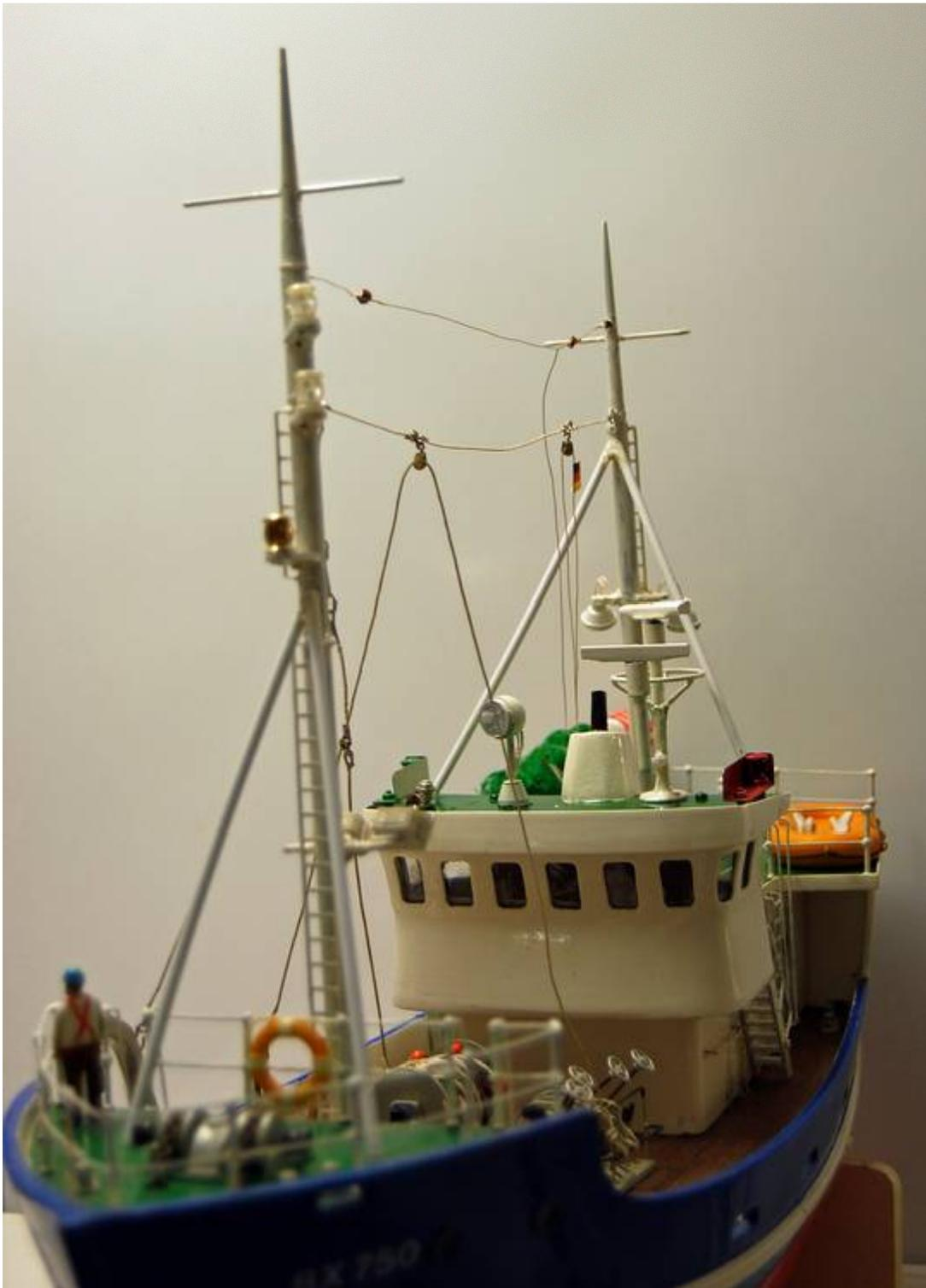
Bild 25: Beide Masten eingebaut und verspannt
