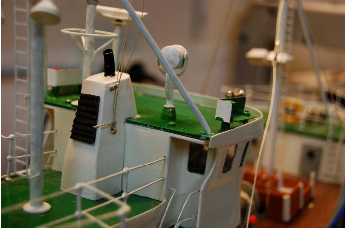
Bild 16: Schornstein mit Auspuffrohr und Luftansaugung
