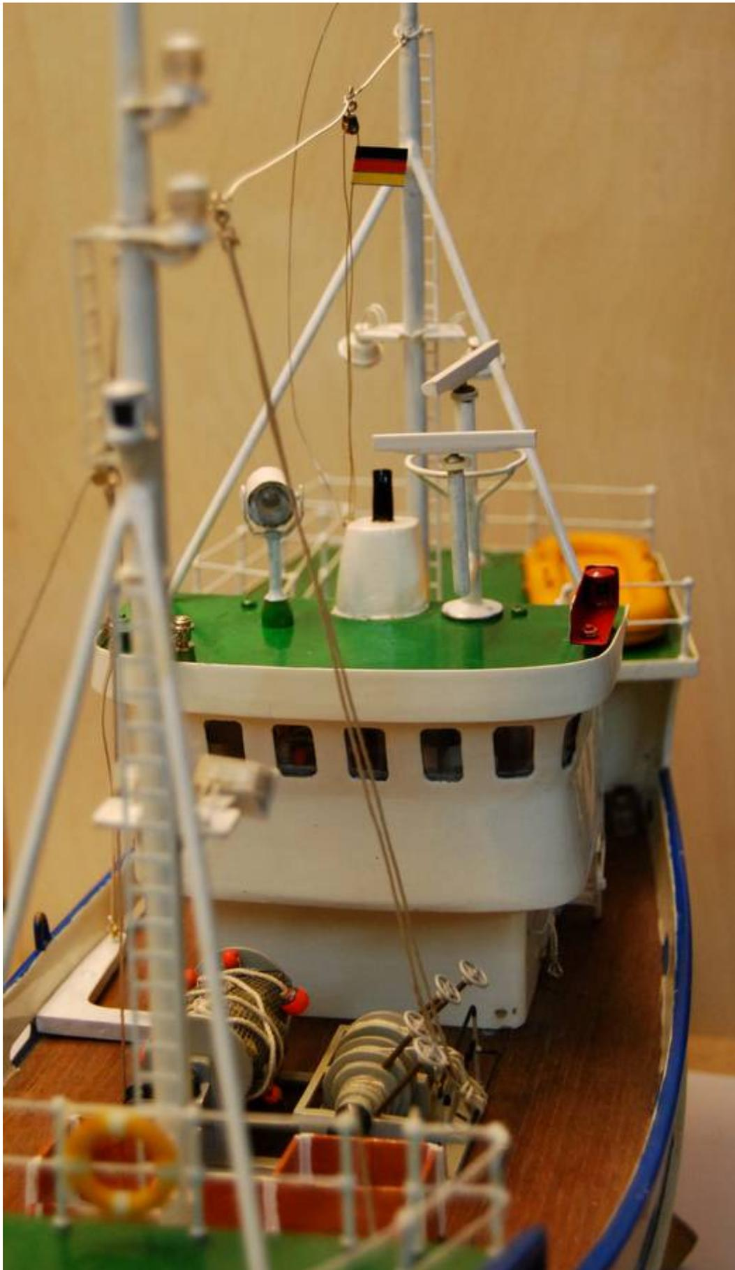
Bild 12: Decksaufbau mit Suchscheinwerfer und Radar
