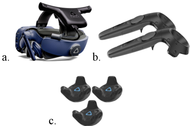
Figure 2. Équipements portés par le patient : a. Casque de réalité virtuelle sans fil HTC VIVE Pro ; b. Contrôleurs HTC VIVE ; c. Traqueurs supplémentaires HTC VIVE.
