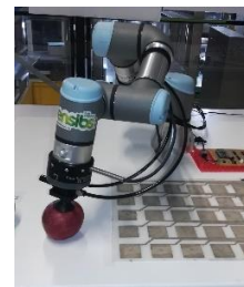
Figure 7. UR3 effectuant des gestes sur un plan de travail (prendre un aliment)
