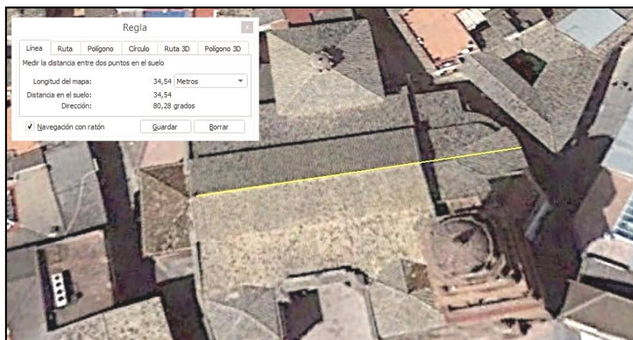
Fig. 4. Ejemplo de medida del azimut de la iglesia parroquial de San Bartolomé Apóstol, en Montoro (Córdoba), a partir de imagen satelital con el software de Google Earth Pro. La medida se repite n_t veces (5–6) usando series históricas de fotografías, trazos de líneas base usando caballete y aleros de cubiertas, y rotando la imagen en pantalla.
