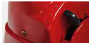
»SHIFT ON THE GO« Transmatic-Getriebe mit 6 Vorwärts- und 6 Rückwärts-Geschwindigkeiten
