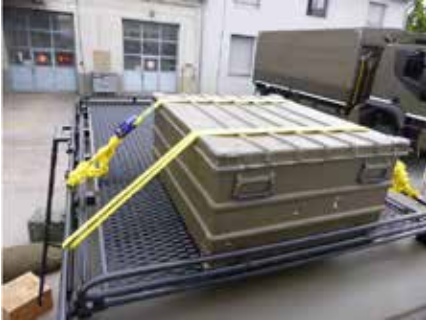
Abbildung 40: Kiste gesichert mit Umreifungsgurt mit Ratsche
