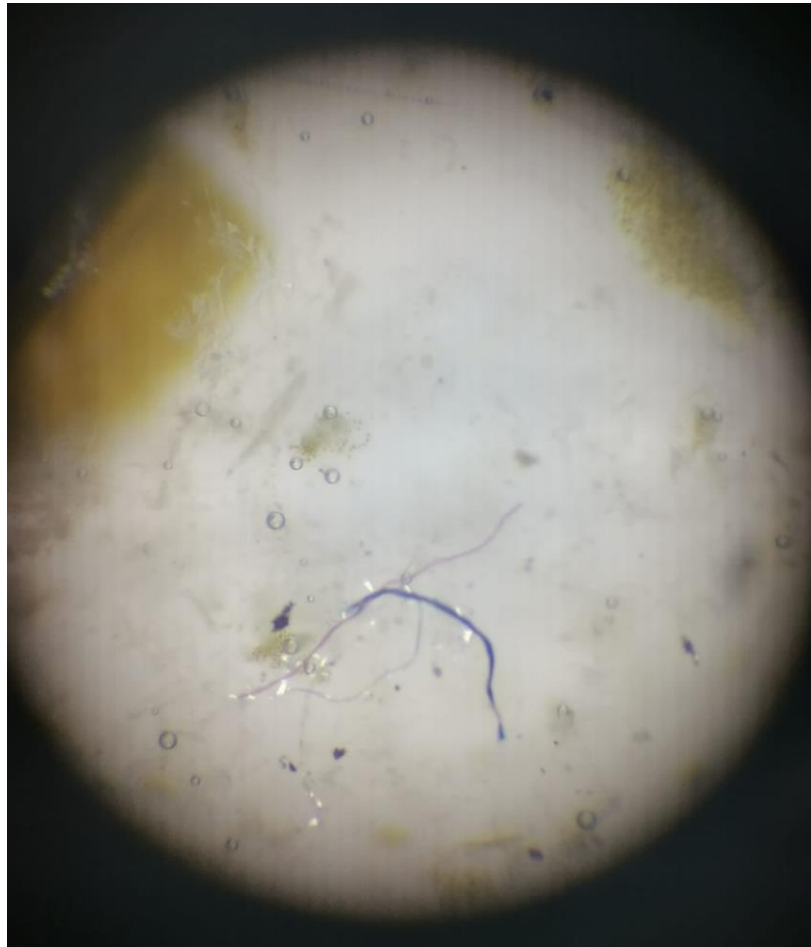
Fig. 1: Filamento plastico di colore blu osservato allo stereomicroscopio
