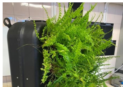
Fig 1. Singolo modulo del biofiltro botanico (dimensioni: 51.5x50x11 cm)
