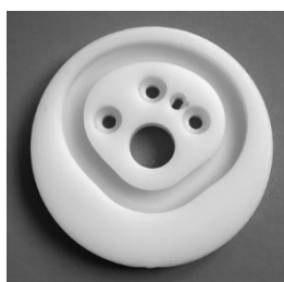
Abb. 13; Kurvenscheibe einer Brother-Nähmaschine
