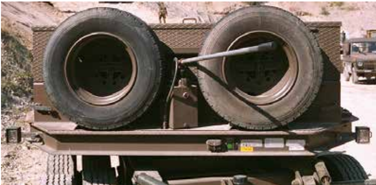
Figure 3 - Pompe hydraulique avec levier de commande
