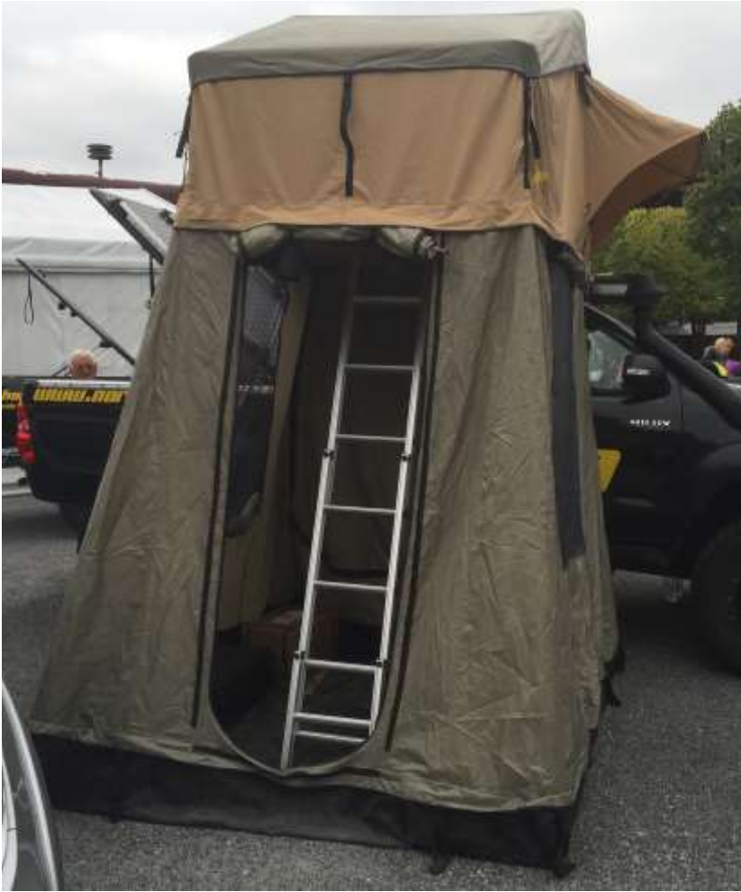
Leiter-Verlängerung um 54cm (geeignet für Offroad Fahrzeuge ab 210cm )
